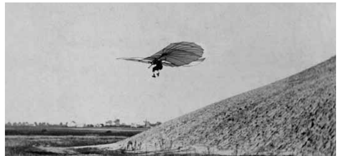
Ein Flug Lilienthals vom Fliegeberg Lichterfelde in Berlin. Die Erhöhung legte er eigens für die Flugversuche an.
